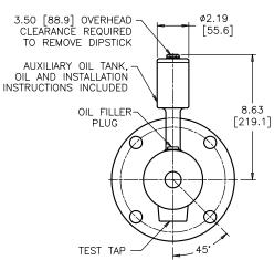
FLANGE ALIGNMENT DIAGRAM SHOWN HORIZONTALLY MOUNTED TOP VIEW
